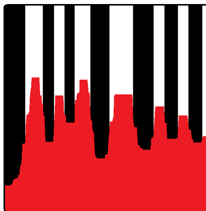
Slika 3.19: Predznak Laplaceovega operatorja določa dele akumulacijskega polja, katerim se povečuje vrednost. Beli pasovi ustrezajo delom histograma, za katere velja \Delta_D f < 0 .
