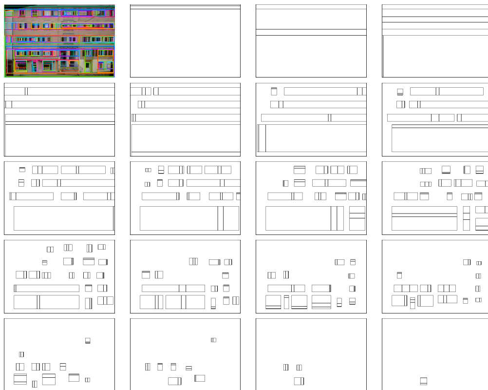
Slika 3.16: Izris drevesne strukture po nivojih. Vsako vozlišče drevesne strukture določa hipotezo o položaju in velikosti okna na fasadi, zato morajo heuristične ocene ovrednotiti vse generirane hipoteze. Za lažjo sledljivost vrednotenja posameznih hipotez, bomo uporabljali izris drevesne strukture po nivojih. V zgornjem levem kotu so prikazana področja, ki ustrezajo posameznim hipotezam, sledijo izrisi področij ločeno po nivojih. Vsaka naslednja slika (gledano z leve proti desni) prikazuje sinove vozlišč prejšnje slike.
