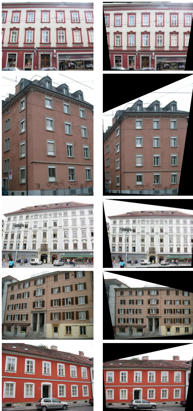
Slika 3.5: Primeri rektifikacije slik. V levem stolpcu so slike fasad s perspektivno projekcijo. V desnem stolpcu so perspektivno izravnane slike.
