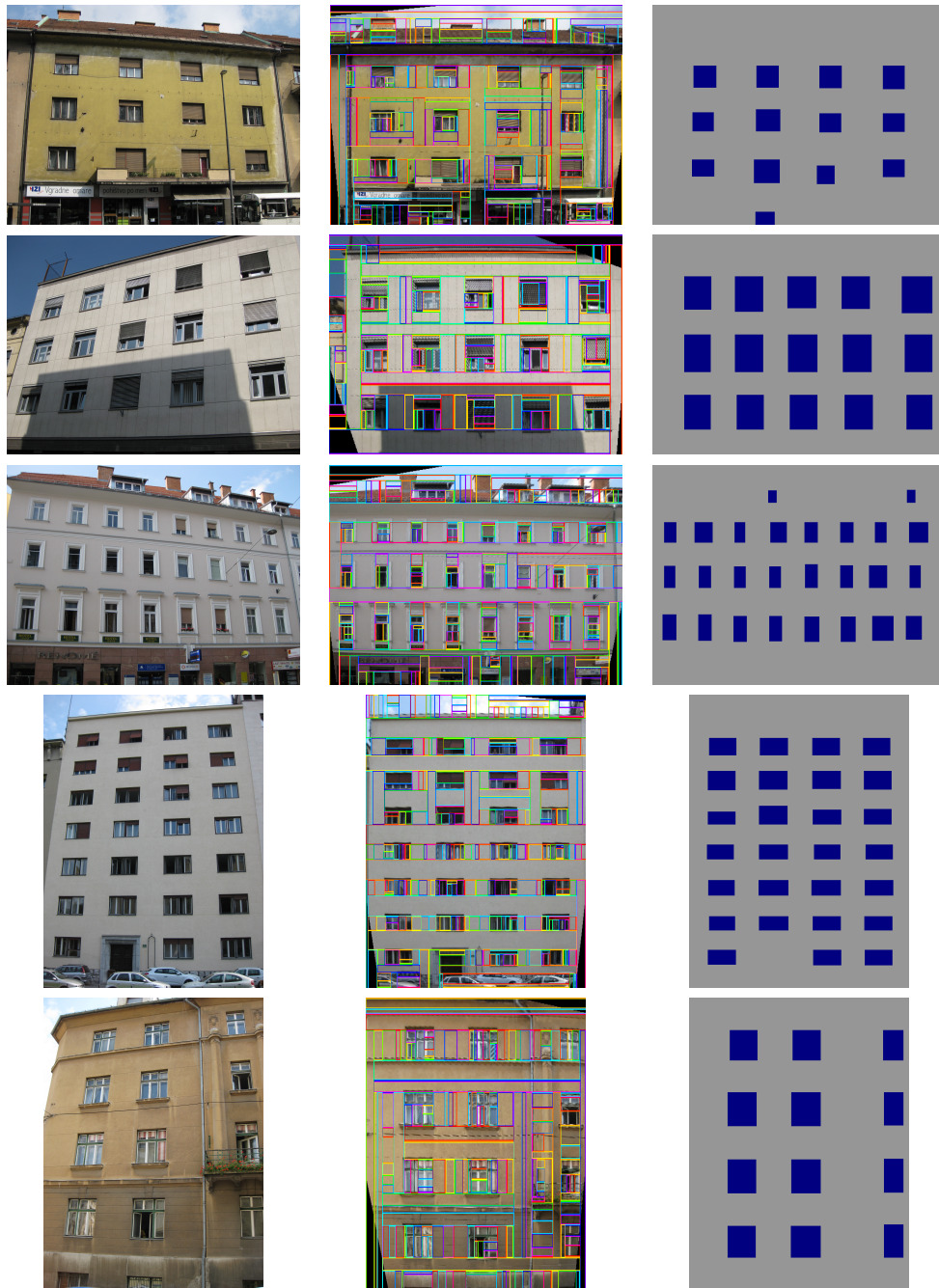
Slika 4.6: Slika prikazuje primere uspešno generiranih hipotez. V levem stolpcu so vhodne fotografije. Srednji stolpec so segmentirane perspektivno izravnane slike. Desni stolpec so generirane končne hipoteze. Opažamo, da se tudi na isti fasadi okna razlikujejo po izgledu (nekatera so odprta, imajo spuščene rolete ali se nahajajo v senci). Kljub temu so dobljene končne hipoteze kvalitetne zaradi izrazite poravnaniosti oken.
