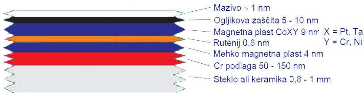
Slika 4 : Struktura plasti zgradbe plošče
