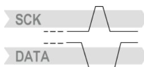
Slika 3.5: Potek potrditvenega zaporedja ukaza ACK senzorja SHT11
