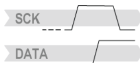
Slika 3.2: Potek začetnega zaporedja ukaza STOP protokola I2C
