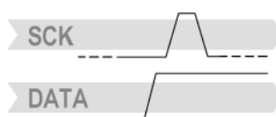
Slika 3.6: Potek potrditvenega zaporedja ukaza NACK senzorja SHT11
