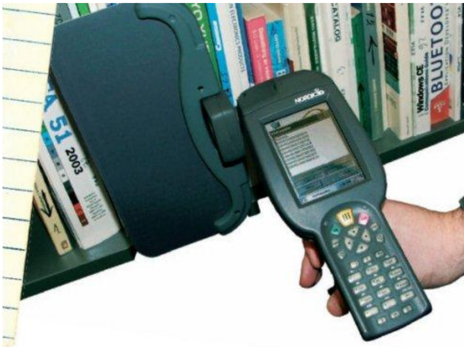
Slika 15: Ročni terminal Nordic ID PL3000 z vgrajenim čitalnikom RFID (Vir: http://www.leoss.si )
