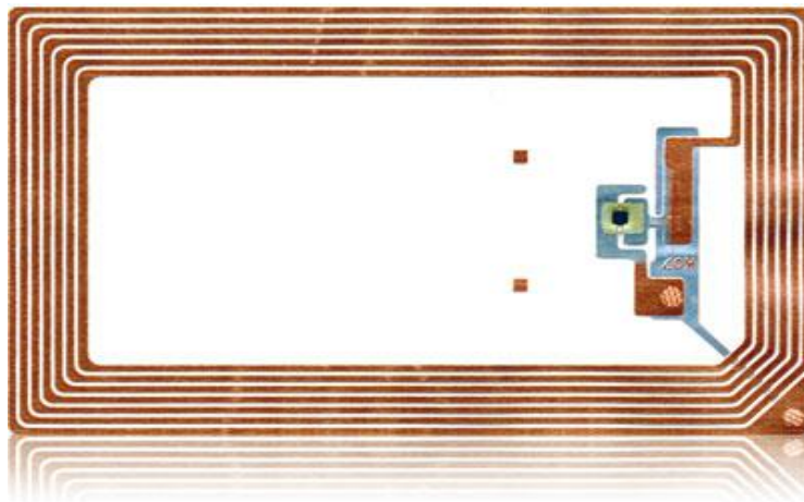
Slika 1: Prikaz antene in integriranega vezja odzivnika RFID (Vir: http://www.jltrfid.com/default.asp?sec=61&langid=2 )
