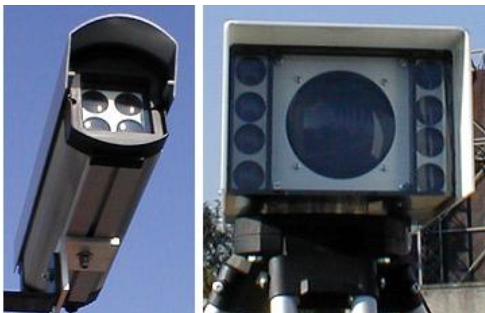
Slika 5: Primera sprejemno - oddajnih enot. Prva ima tri oddajnike in en sprejemnik. Vsi imajo enake leče. Desna enota ima 8 oddajnikov in en sprejemnik. Sredinska leča je sprejemna, manjše stranske so oddajne. Enote so izdelali na TU Graz [14].
