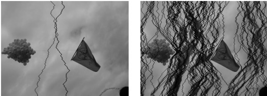
Slika 2.4: prikaz optimalnih šivov, izris šivov s programom GIMP [10]. Levo: prikaz dveh šivov, desno: prikaz 100 šivov (število šivov rezanih na sliki 2.3)
