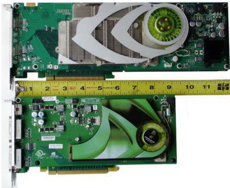
Slika 13: Primerjava med prvo uradno dvoprosorsko karto 7900GX2 (zgoraj) in njeno naslednico 7950GX2 (spodaj).
