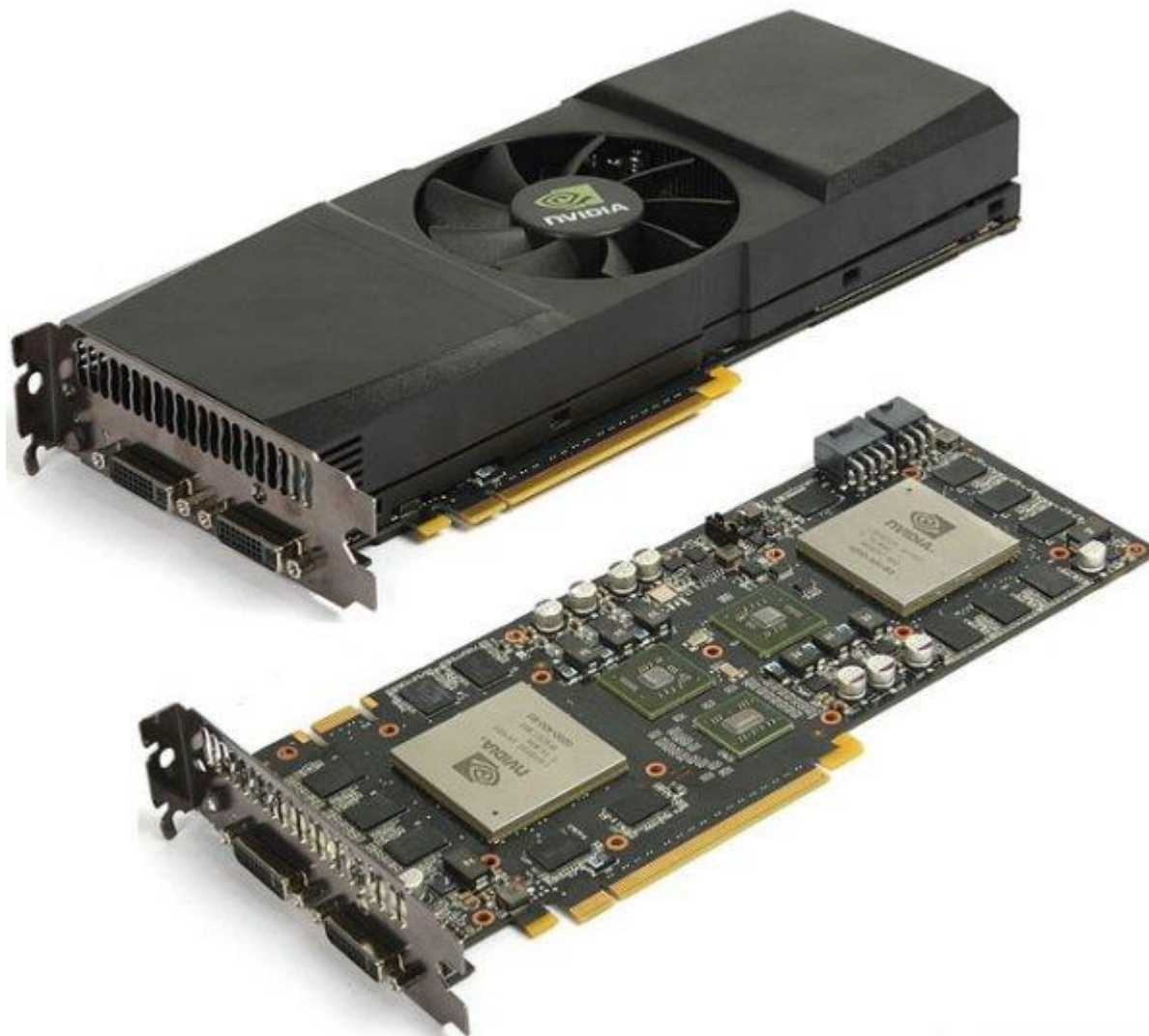
Slika 5: Manj pregrevanja, nižji stroški izdelave. GTX 295 SinglePCB .
