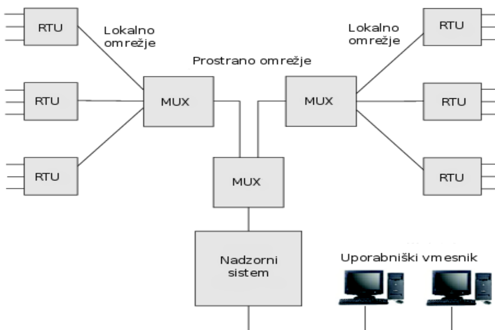
Slika 17: Primer sistema SCADA tretje generacije
