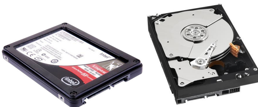
Slika 32: Pogon SSD Kingston Intel SSD SNM125-S2 80 GB in Magnetni disk WD Caviar Black WD7501AALS (povzeto po [5])
