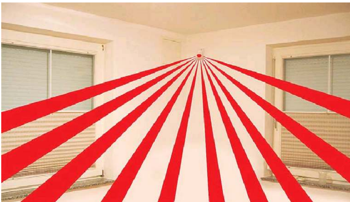
Slika 5: Pravilna postavitev notranjega infrardečega senzorja premika med dvema oknom [8].
