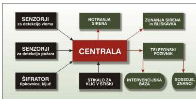
Slika 1: Shema protivlomnega alarmnega sistema [3].
