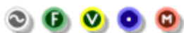
Slika 28: Primerjava konektorjev (od leve proti desni): večvhodni konektor za zvočni signal, konektor za podatkovni tok s plavajočo vejico, konektor za modificiranje grafičnega vmesnika, mono konektor za zvočni signal, MIDI konektor
