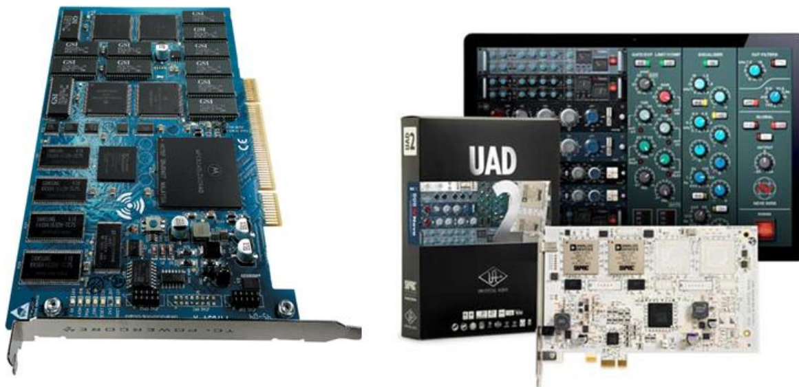
Slika 5: Primer vtičnika z namensko platformo in njegove PCIe karte (desno), PCI karta z DPS vezjem (levo)
