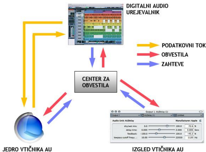
Slika 8: Komunikacija med vtičnikom AU in gostiteljem
