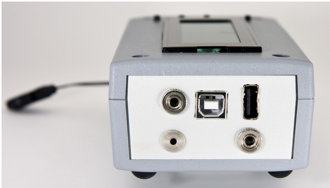
Slika A.10: Slika priključkov na napravi. Od leve proti desni si v zgornji vrsti sledijo: izhod za proženje fotoaparata, vhod USB za povezovanje z osebnim računalnikom ter priključek zunanje napajanja, splošni priključek tipal. V spodnji vrsti: izhod za proženje bliskavice, mikrofonski vhod.
