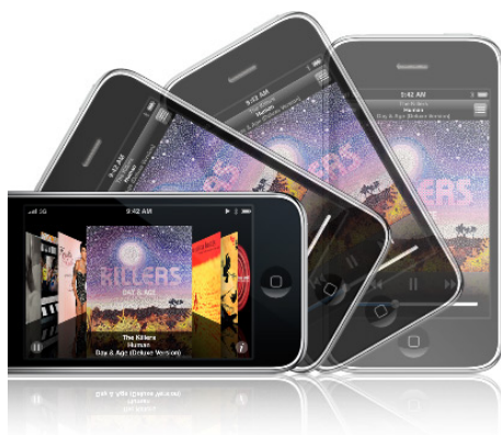
Slika 2.2: Pokončen in ležeč način uporabe s senzorjem za merjenje pospeška
