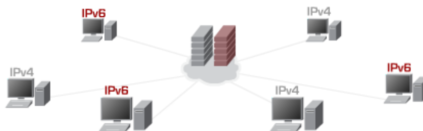
Slika 13: Uporaba dvojnega sklada : razvoj IPv4 in IPv6 na isti infrastrukturi
