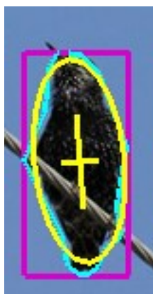
Slika 8: Ptica in geometrijske informacije. Vijolična – očrtan pravokotnik, svetlo modra – krivulja obrisa, rumeno – krivulji obrisa prilegajoča se elipsa.
