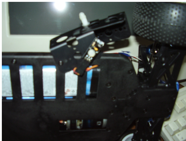
Slika 3.13: Senzor odbojnega koeficienta - pogled izpod vozila
