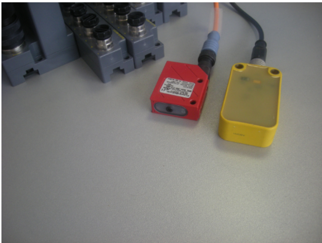
Slika 39: Senzorja za zaznavanje objektov, senzor rumene barve je analogni induktivni senzor Bi15-Q20-LI2-H1141, senzor rdeče barve pa digitalna fotocelica HRTL8/24-350-S12
