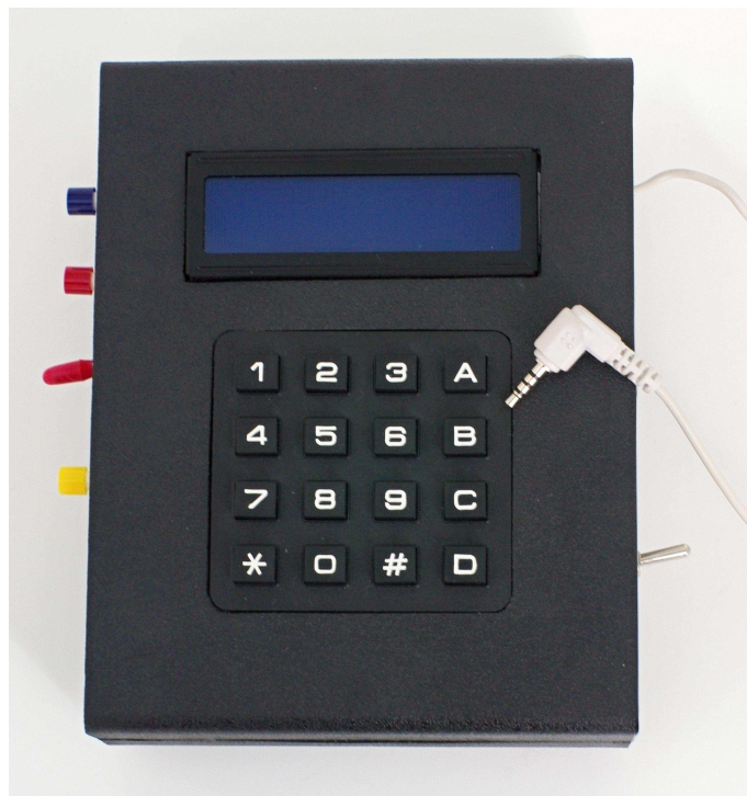
Slika A.1: Intervalometer (sprednja stran).
