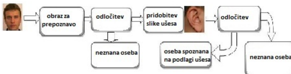
Slika 2.21: Sistem prepoznave obraza v kombinaciji z ušesi.
