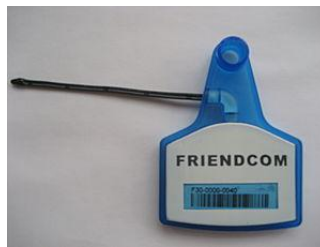
Slika 10. Aktivna RFID značka s temperaturnim senzorjem Shenzen Friendcom [1].
