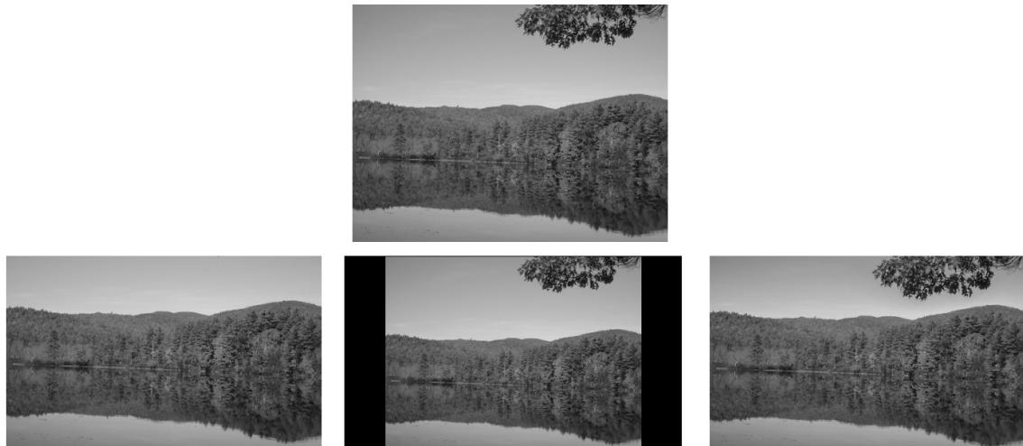
Slika 2.1: Primerjava algoritmov za spremjanje velikosti slik. Zgoraj je prikazan izvorna slika, ki jo želimo prikazati na zaslonu manjše velikost. Levo je prikazana rešitev z enostavnim rezanjem slike, na sredini je rezultat zmanjševanja v merilu, na desni pa rezultat po izvajanju algoritma Seam Carving
