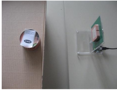
Slika 26. Testiranje izdelka v pločevinasti ali kovinski embalaži.
