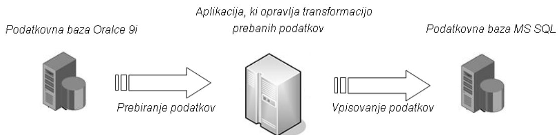
Slika 6: Postopek eksplicitnega prepisovanja podatkov iz podatkovne baze Oracle 9i v podatkovno bazo Microsoft SQL.
