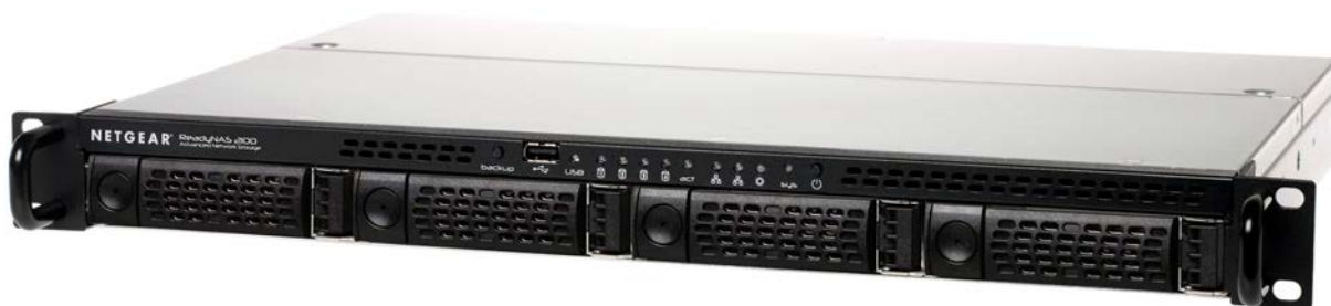
Slika 14: Omrežno diskovno polje Netgear ReadyNAS 1100
