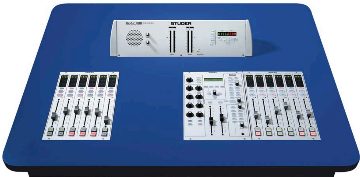
Slika 17: Digitalna zvočna mešalna miza Studer OnAir 500 Modulo
