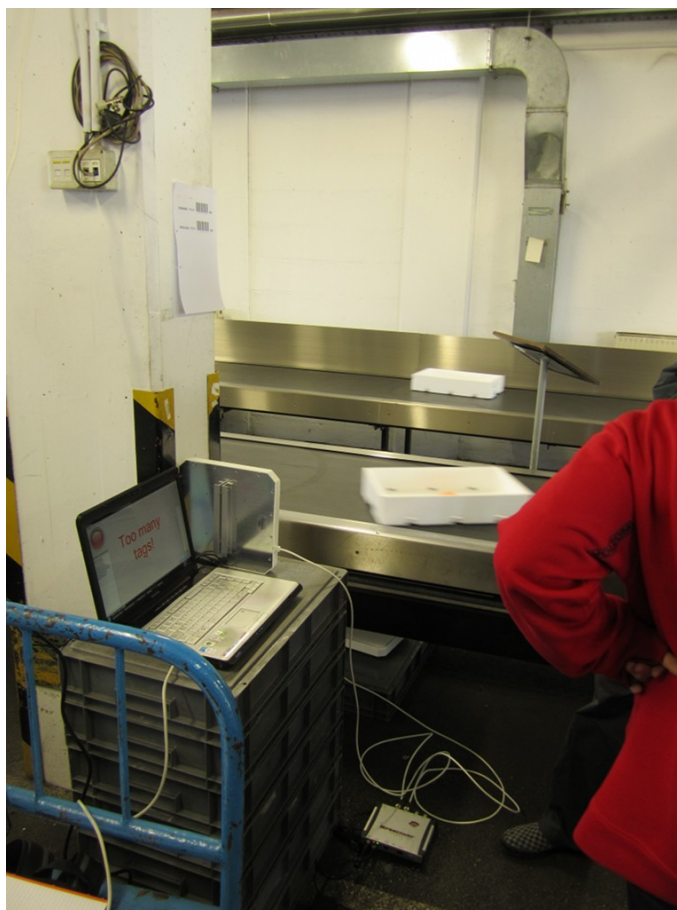
Slika 26: Premočne nastavitve moči anten in več prebranih RFID značk hkrati
