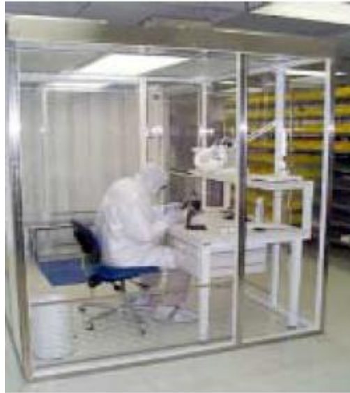
Slika 21: Popravilo v notranjosti trdega diska se izvaja v izjemno čistem okolju
