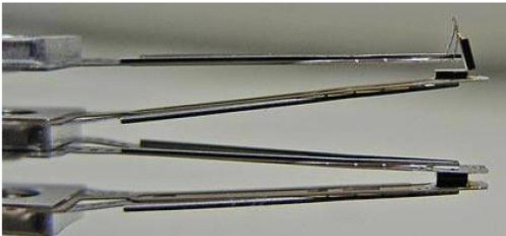
Slika 24: Prikaz poškodovane in zlepljene bralno-pisalne glave
