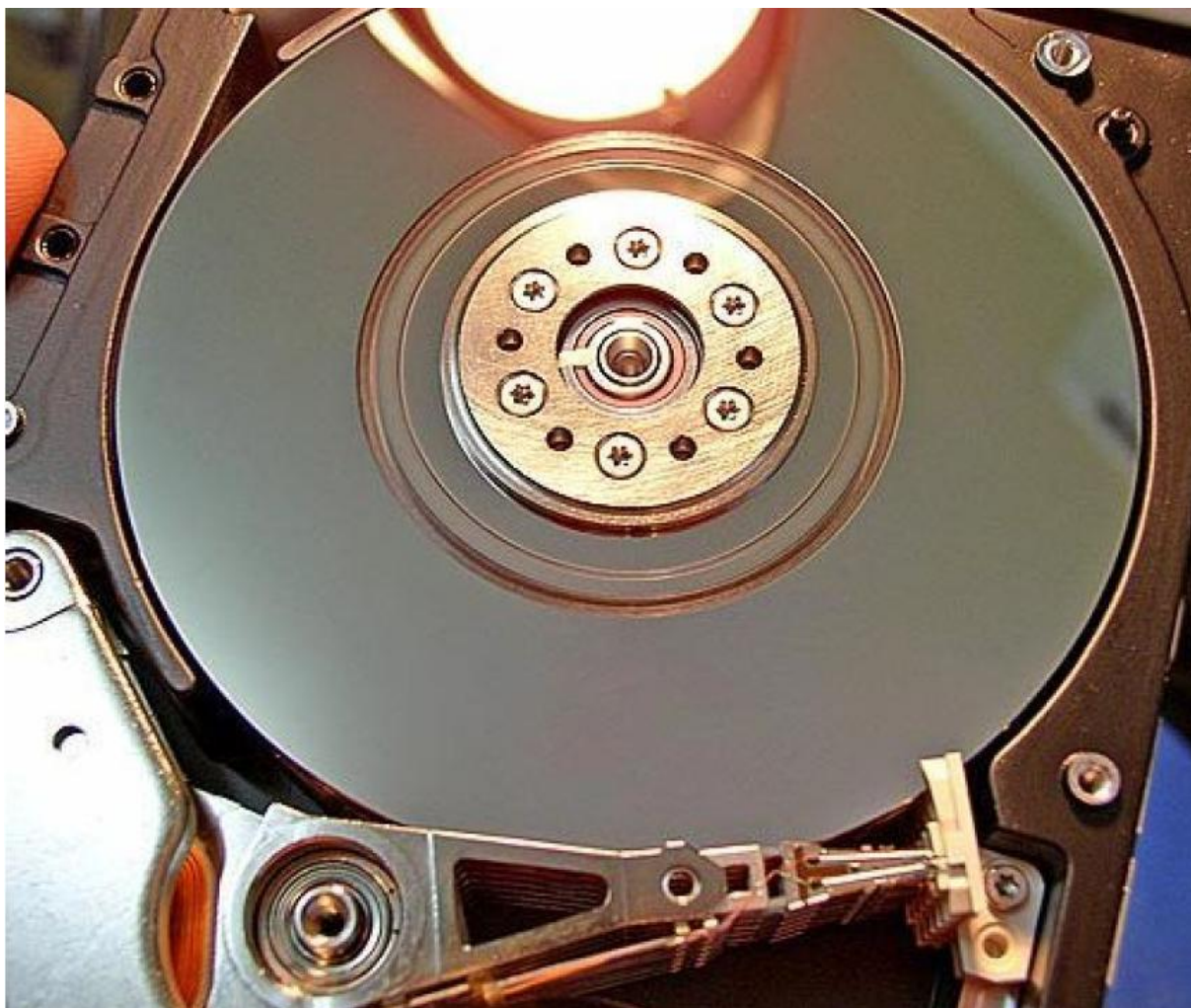
Slika 28: Poškodba plošče (tako imenovani padec glave) vidna v obliki koncentričnih krogov na notranjem delu plošče.
