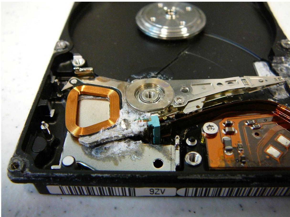
Slika 29: Poškodovan trdi disk zaradi vode
