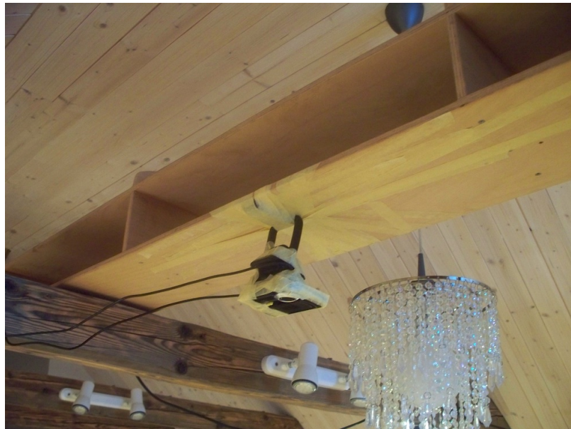
Slika 5.4: Spletni kameri Logitech HD Pro Webcam C910 in Logitech QuickCam Pro 9000 pritrjeni nad poligonom.
