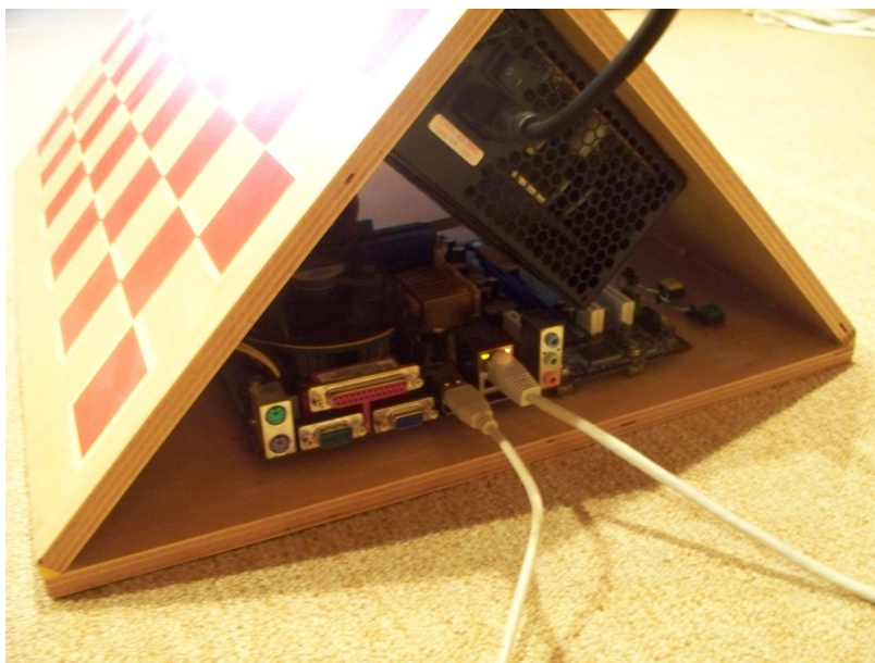
Slika 5.11: Kalibracijski objekt vsebuje na eni strani prazen prostor, v katerega se lahko parkira robot. Na tej strani pa vsebuje krmilni računalnik.
