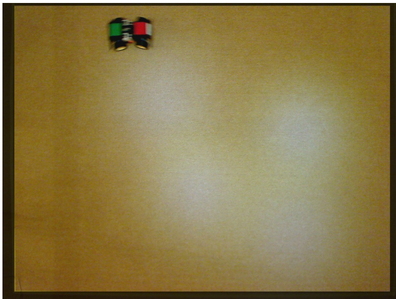
Slika 5.7: "Razmazani" markerji zaradi gibanja robota, ki nimajo jasne meje. Hkrati se vidi tudi vpliv perspektive, saj so markerji precej zamaknjeni glede na sredino robota glede na ravnino poligona.
