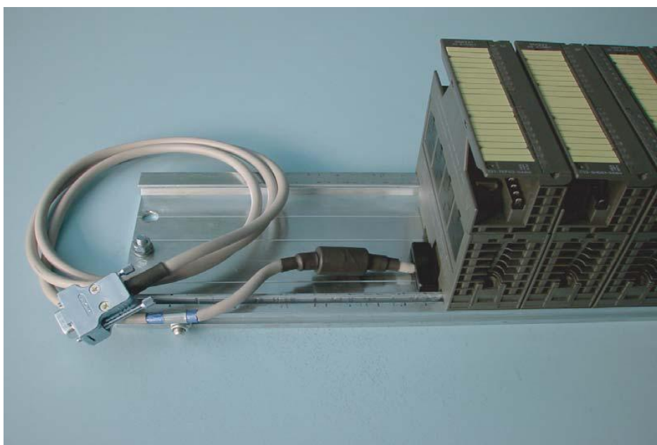
Slika 4.7. Priklop dodatnih modulov preko razširitvenega kabla [4]
