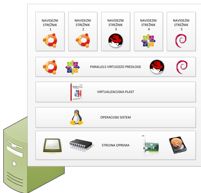
Slika 12: Virtualizacija z Parallels Virtuozzo na sistemu Linux
