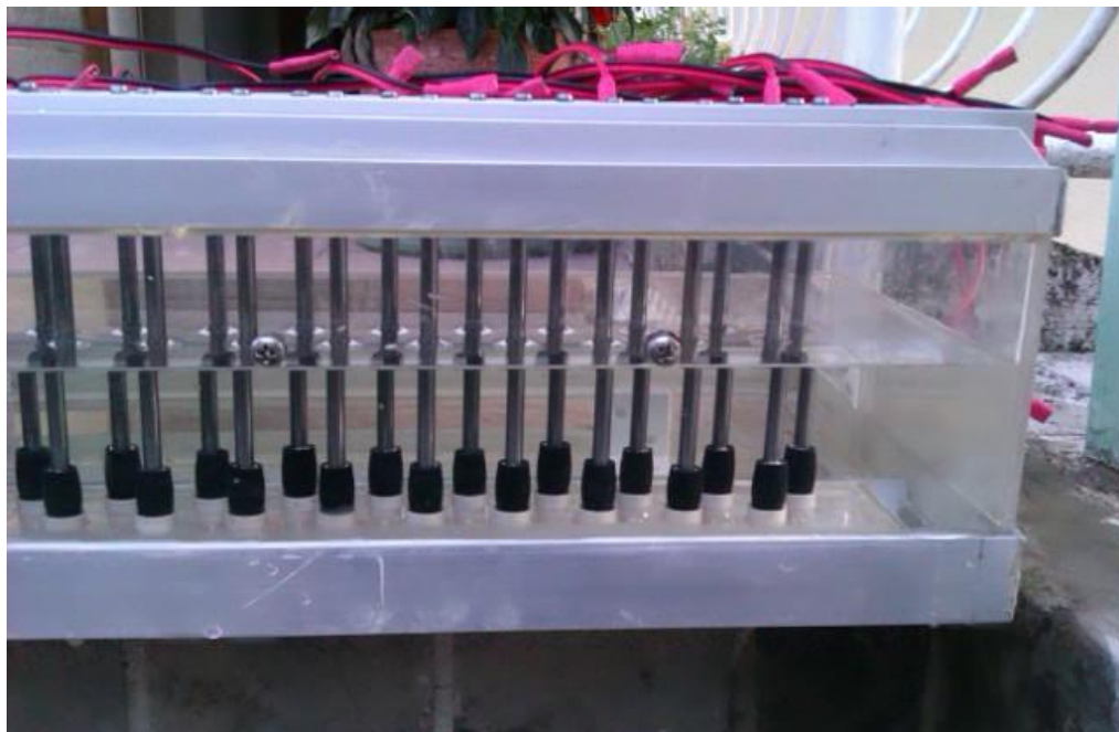
Slika A.2: Vodni tiskalnik (pogled na šobe).
