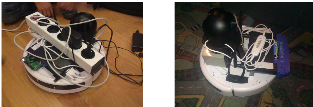
Slika 6.2: Razlika med končanim sistemom z zunanjo baterijo (desno) in brez (levo)
