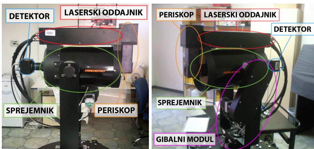
Slika 1.1: Poglavitni deli LiDARskega sistema so: laserski oddajnik (izvor svetlobe), sprejemni teleskop ter detektor signala.
