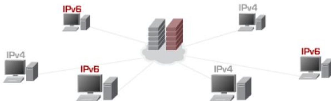
Slika 9: Uporaba dvojnega sklada: razvoj IPv4 in IPv6 na isti infrastrukturi.
