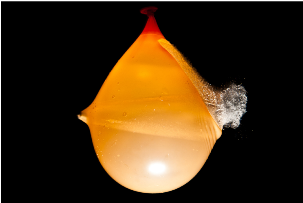
Slika 12: Vodni balon v trenutku zadetka krogle zračne puške. Hitrostni sprožilec z dodatno zakasnitvijo 0.7 ms (60 mm f/3.5 @ 1.8 s, ISO 800).
