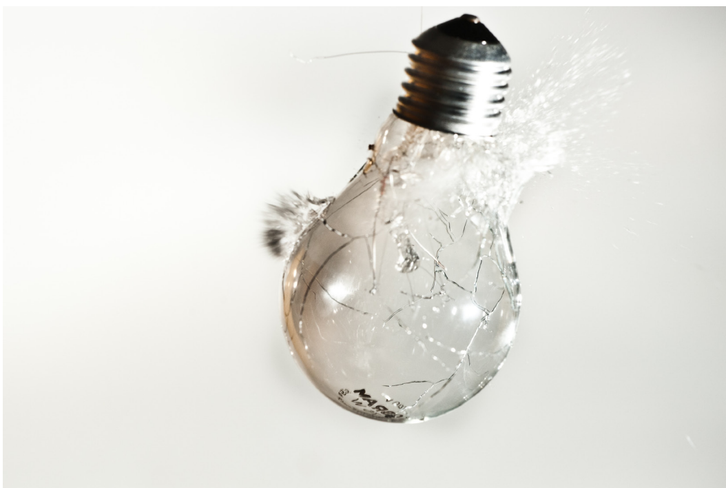
Slika 9: Žarnica v trenutku zadetka kroglice zračne puške. Hitrostni sprožilec z dodatno zakasnitvijo 0.3 ms (150 mm f/8 @ 3.6 s, ISO 1600).
