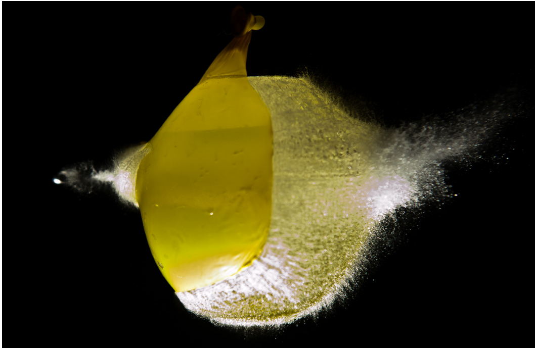
Slika 13: Vodni balon v trenutku zadetka krogle zračne puške. Hitrostni sprožilec z dodatno zakasnitvijo 0.9 ms (60 mm f/4.5 @ 1.6 s, ISO 1000).
