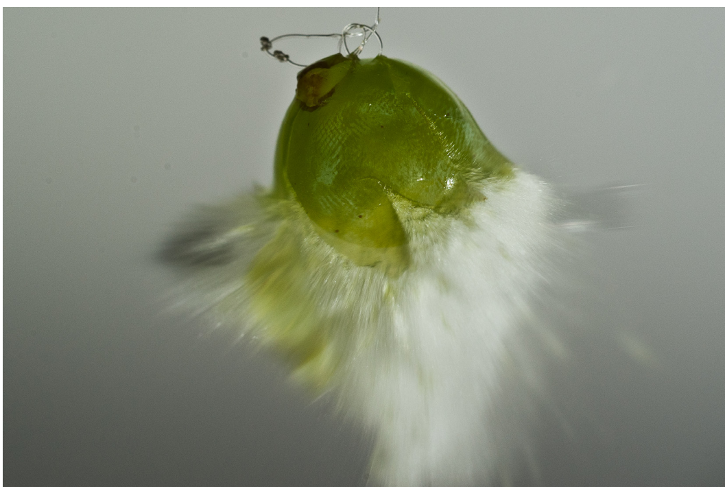
Slika 8: Grozdna jagoda v trenutku zadetka krogle zračne puške. Hitrostni sprožilec z dodatno zakasnitvijo 0.1 ms (150 mm f/10 @ 1.7 s, ISO 1600).
