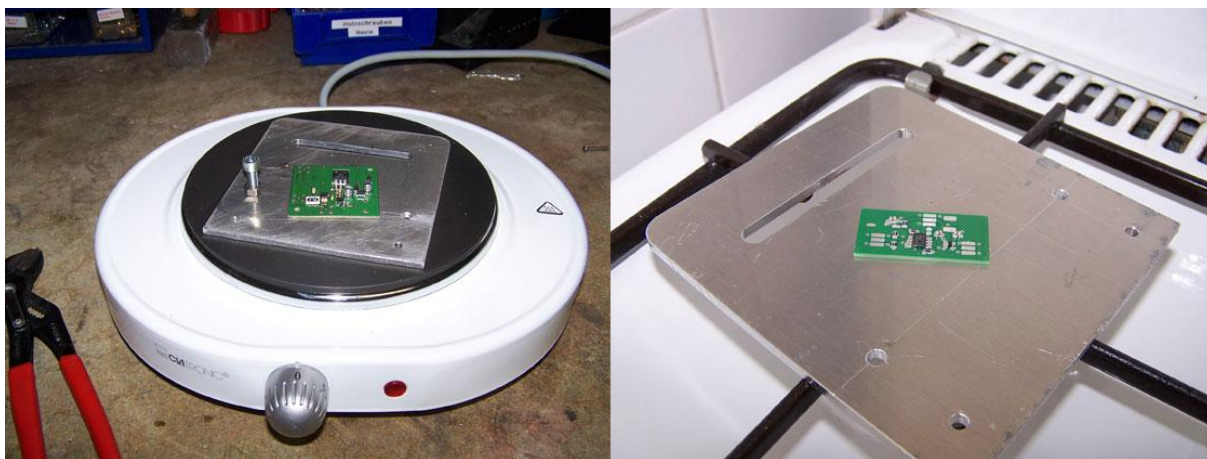
Slika 26: Primer popravila na električni grelni plošči oz. na plinskem štedilniku.
