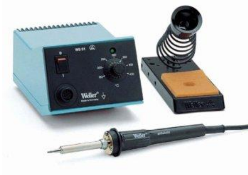
Slika 12: Naprednejši spajkalnik z regulatorjem temperature na spajkalni postaji
