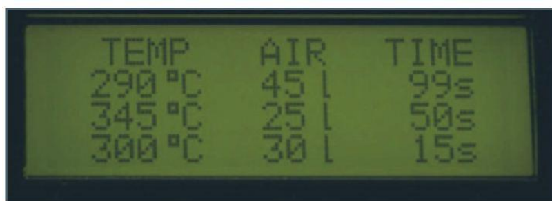
Slika 21: LCD zaslon z nastavitvami parametrov (avtomatski način)
