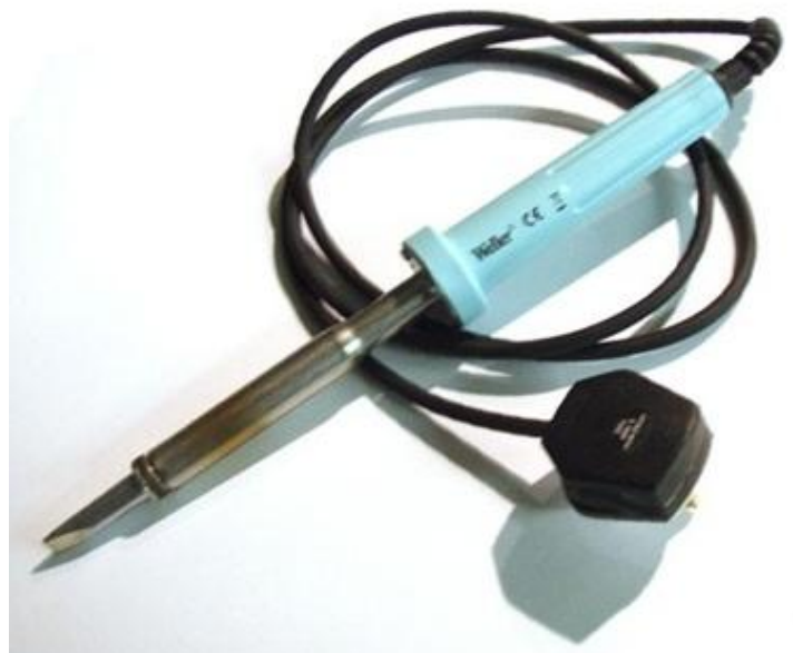
Slika 11: Enostavni električni spajkalnik
