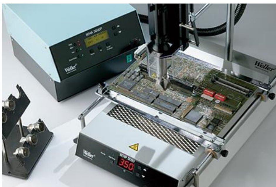
Slika 17: Naprednejša spajkalna postaja na vroč zrak (Weller WHA 3000P)
