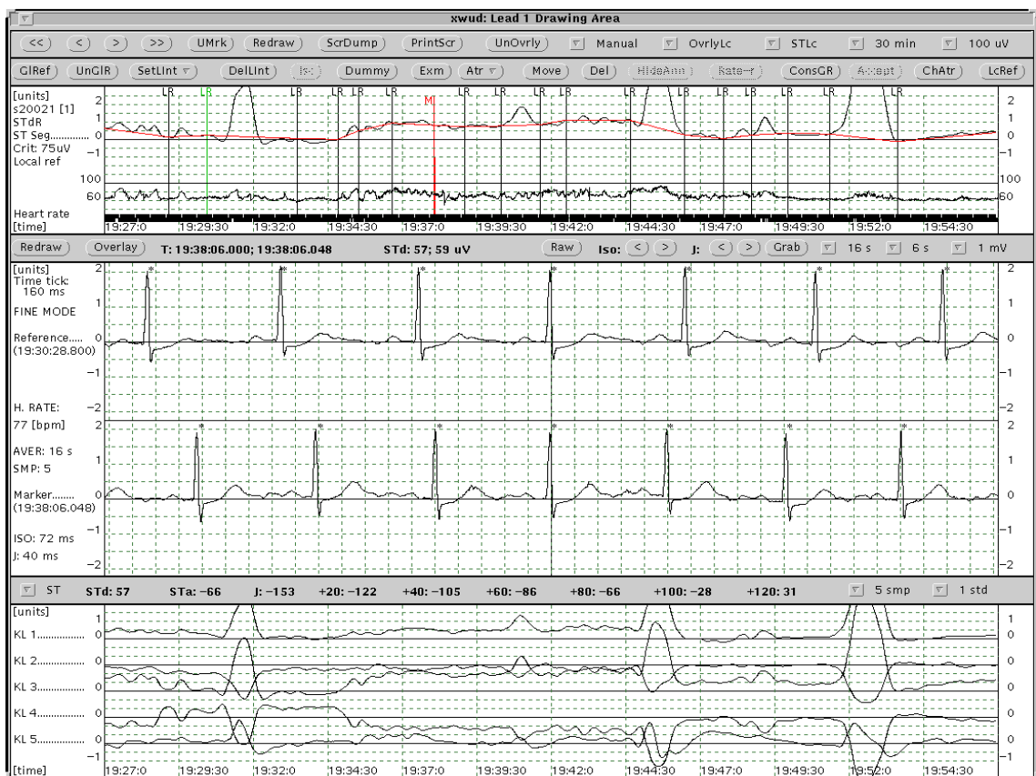
Slika 3-2: Primer označevanja referenčne poti ST z orodjem Semia - Točke LR pomenijo lokalne reference. V srednjem prikazu je izrisan signal EKG pri izbrani točki na gornjem prikazu. Spodnji prikaz kaže funkcije koeficientov transformacije Karhunenena in Loèveja [17], ki so dober in pregleden pokazatelj trendov morfologije signala EKG na izbranem intervalu. (vir: [16][2])
