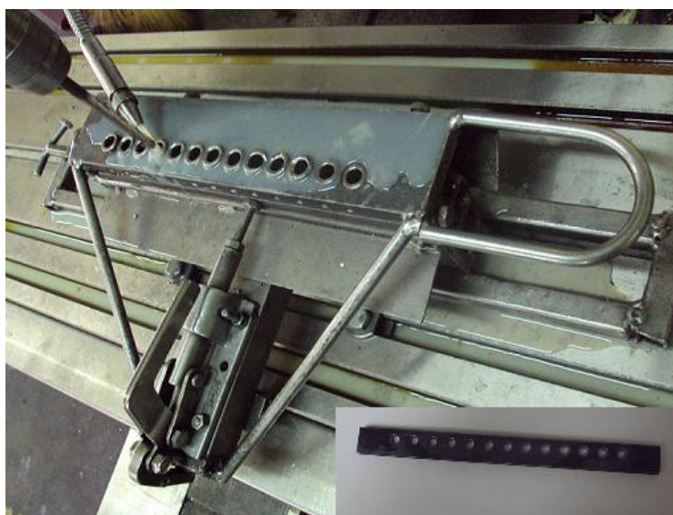
Slika 20: Šablona za vrтанje lukenj v lamo za klešče SZ
