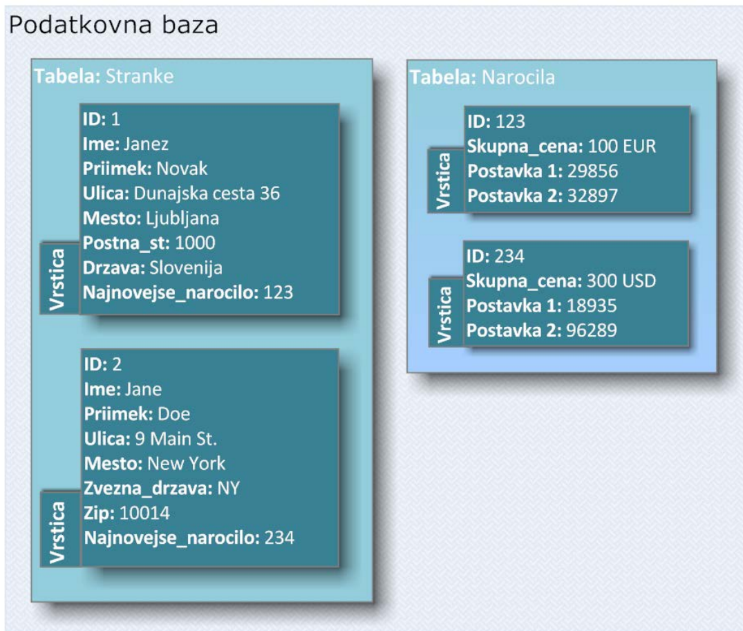
Slika 4.1. Primer podatkovnega modela za shrambo tipa ključ/vrednost
