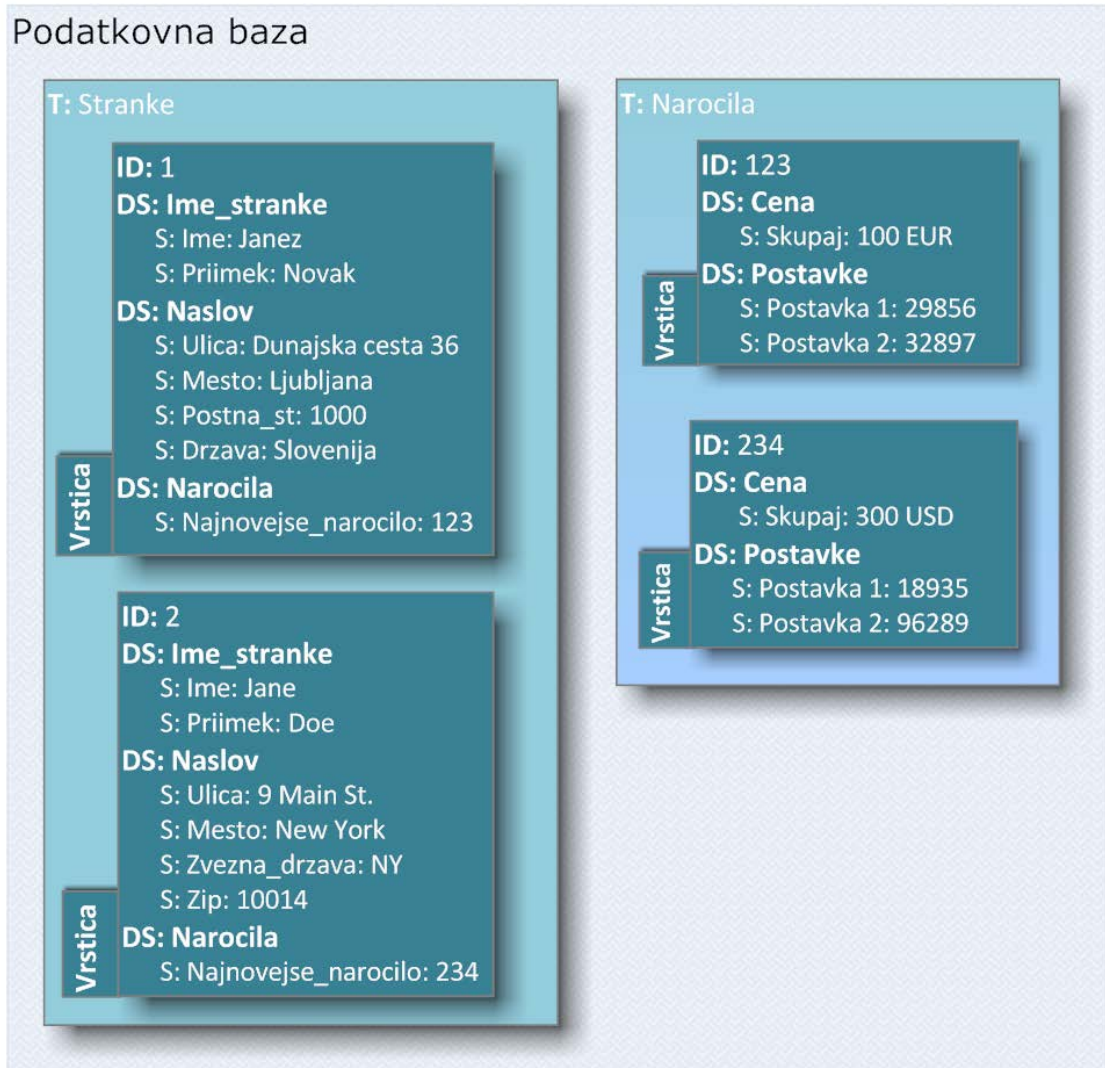
Slika 4.3. Primer podatkovnega modela za shrambo tipa razširljiv zapis
