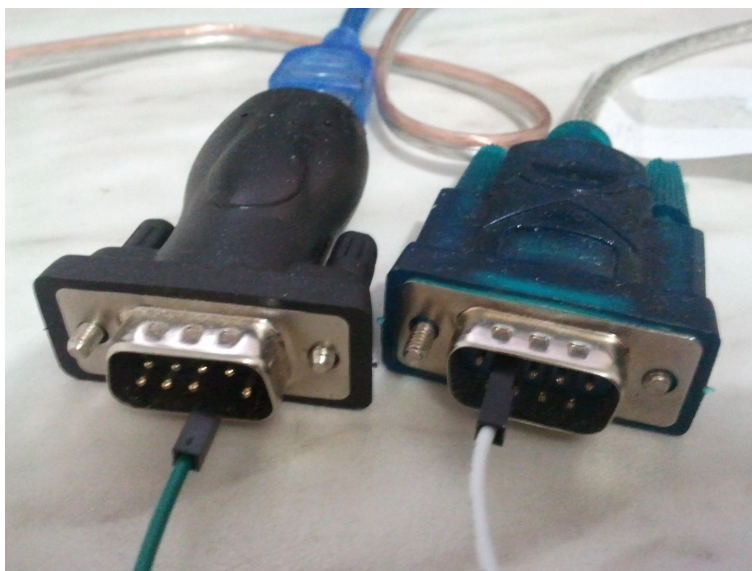
Slika 3.2: Prisluškovanje krmilniku in terminalu z dvema RS-232 adapterjema
