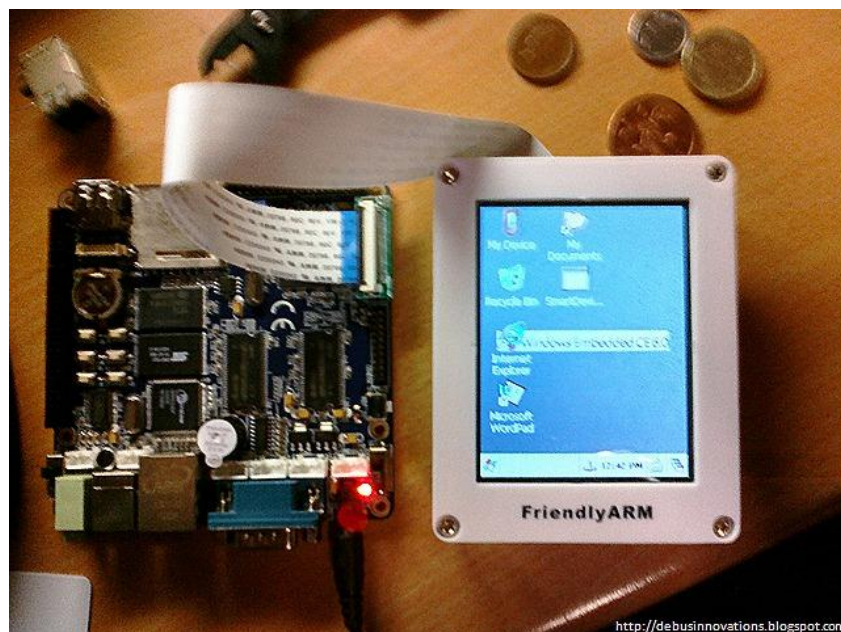
Slika 3-1: Plošča FriendlyARM z zaslonom LCD in naloženim Windows CE 6
