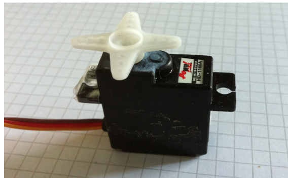
Slika 2.12: Servomotor za radijsko vodene modele
