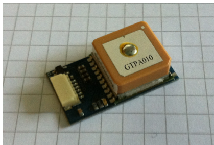
Slika 2.9: MediaTek 3329 GPS modul z anteno
