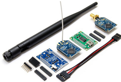
Slika 2.10: Brezžična XBee telemetrija ( Vir [2] )
