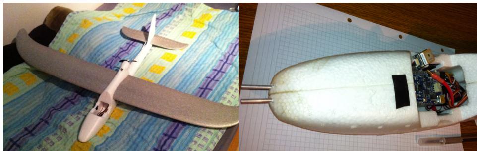
Slika 4.1: Letalo Easystar in pilotska kabina z avtopilotom, GPS modulom in vidno statično in dinamično Pitojevo cevjo.
