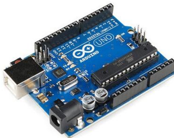
Slika 2: Arduino UNO razvojna ploščica
