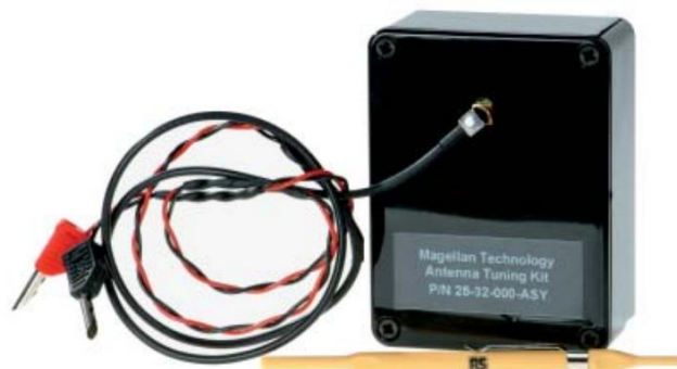
Slika 13: Oprema za vzdrževanje anten.
