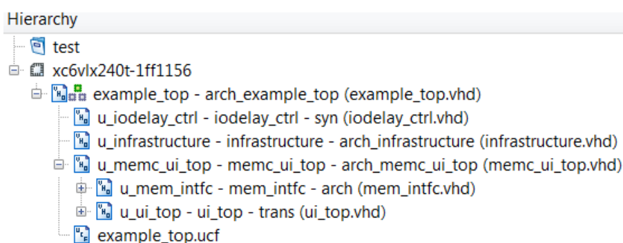
Slika 5.5: Hierarhija projekta s krmilnikom RAM-a, ustvarjena z MIG-om.
