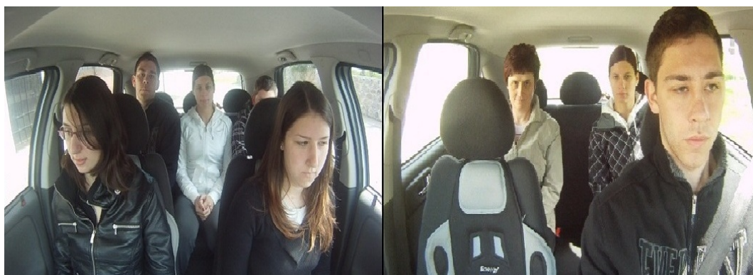
Slika 3.2: Levo je prikazan zajem slike s kotom velikosti 170^\circ , desno pa s kotom velikosti 127^\circ .
