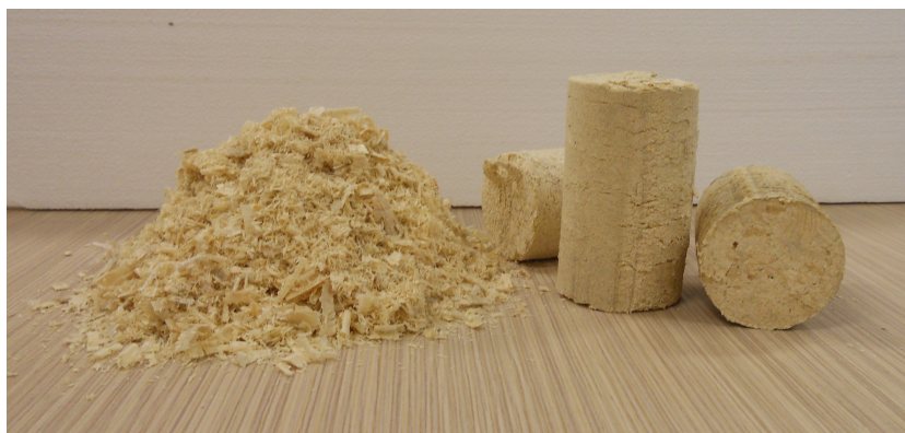
Slika 1.1: Neobdelana žagovina in oblanje na levi, ter izdelani briketi na desni.
