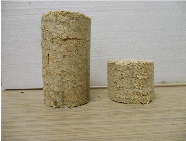
Slika 4.1: Briket izdelan z uporabo dvojnega doziranja na levi in briket z uporabo enojnega doziranja na desni.
