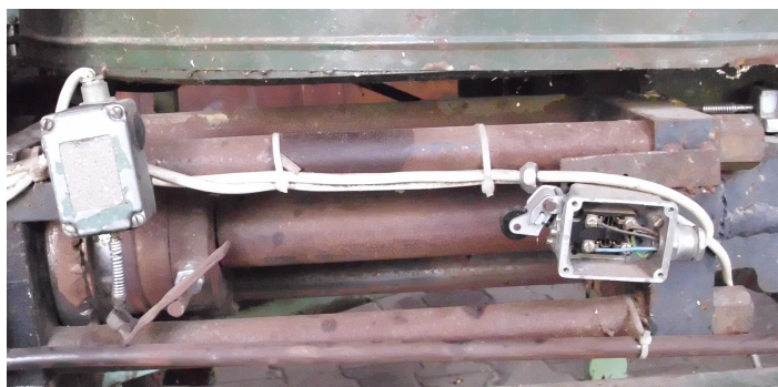
Slika 2.5: Obrabljena mikrostikala v zaščitnem ohišju, ki naj bi preprečevalo stik z vodo in prahom.
