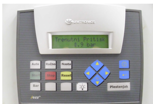
Slika 3.5: Krmilnik z zaslonom in tipkovnico s prilagojenimi tipkami.
