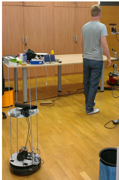
Slika 1.1: Prikaz delovanja sistema detekcije in sledenja človeka na mobilni platformi.
