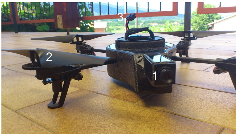
Slika 2.2: Kvadrokoopter brez zaščite s sprednje strani. S številkami so prikazani: 1 - sprednja kamera, 2 - propeler, 3 - priključek za baterijo.
