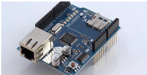
Slika 8: Razširitvena rezina Arduino Ethernet Shield [21]
