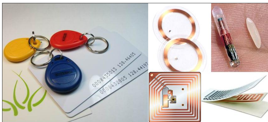
Slika 1: Različne oblike pasivnih RFID značk [[12],[13],[14],[15],[16]]
