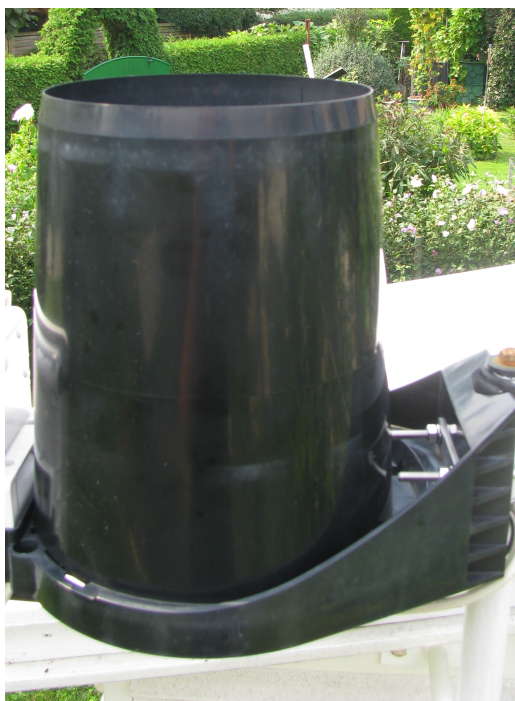
Slika 2.4: Senzor za merjenje količine padavin.
