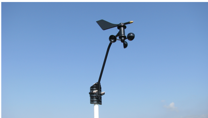
Slika 2.3: Senzor za hitrost in smer vetra (anemometer).
