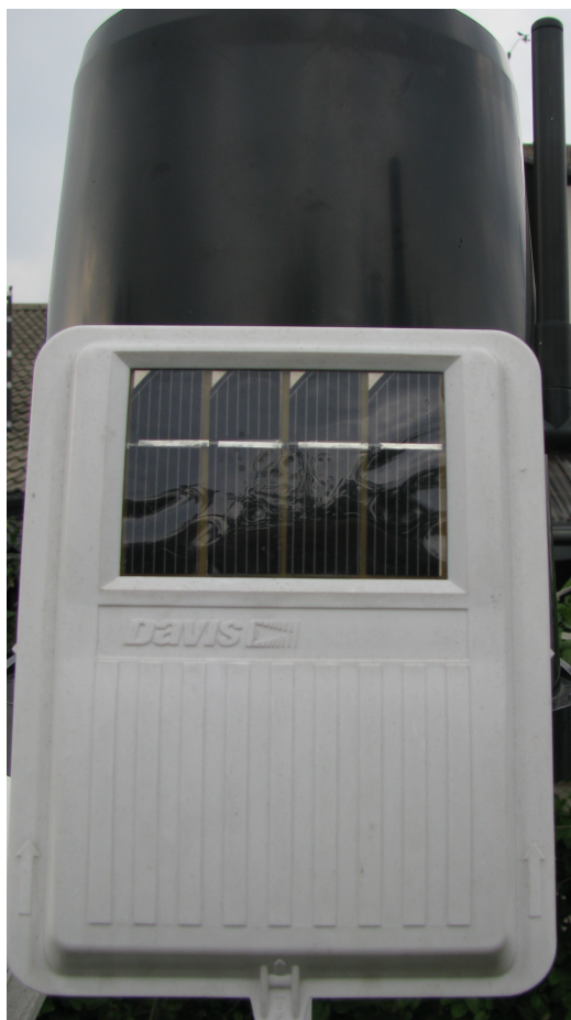
Slika 2.5: Glavna enota z anteno in sončnimi celicami.
